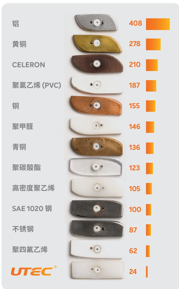
图 4 - 不同等级的 UTEC 与各种材料的相对磨损度，以 SAE 1020 钢为 100。图为受试零件。采用 Braskem 内部砂浆法测量。
